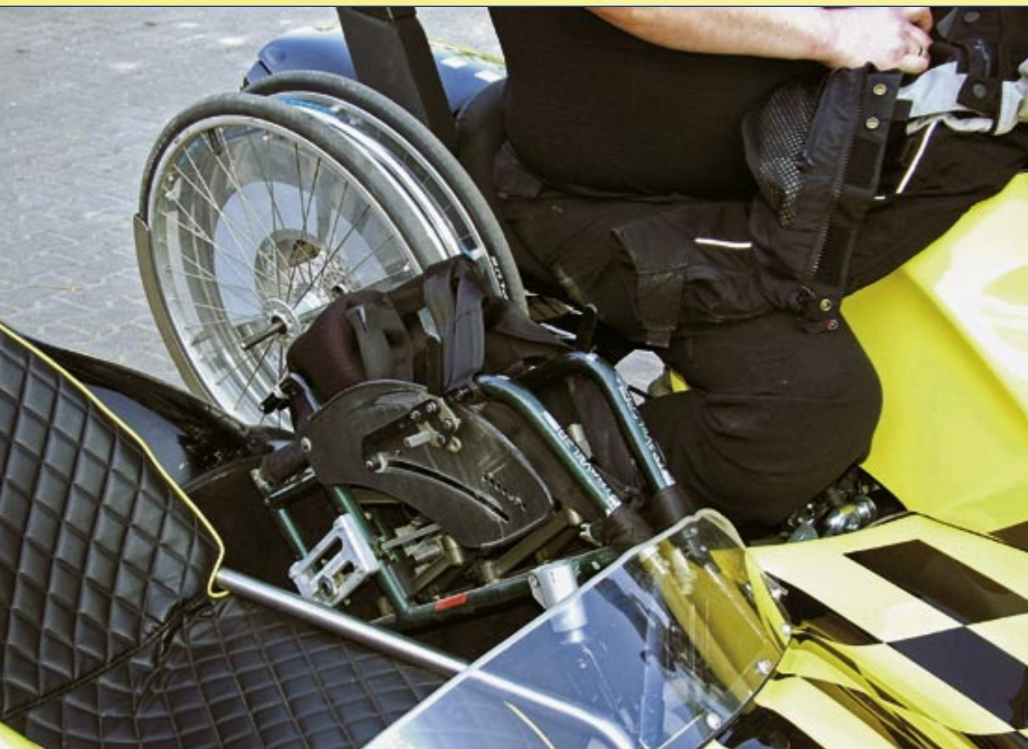
Der Rollstuhl wird im Heck in einer Halterung befestigt. Die Räder wandern ins Boot.
