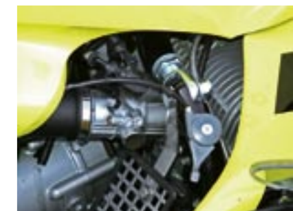
Mit diesem Stellhebel wird der Elektromotor eingekuppelt. Der Antriebsriemen hat dann Kraftschluß zur Riemenscheibe, die zwischen Antrieb und Hinterrad sitzt.
