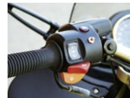
Die Tiptronic wird mit den Blinkerschaltern rechts und links am Lenker betätigt. Als Blinkerschalter dient nun der kleine rote Knopf.
