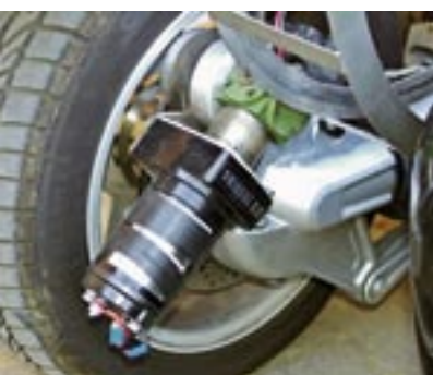
Der kräftige Elektromotor dient als Rückwärtsgang.
