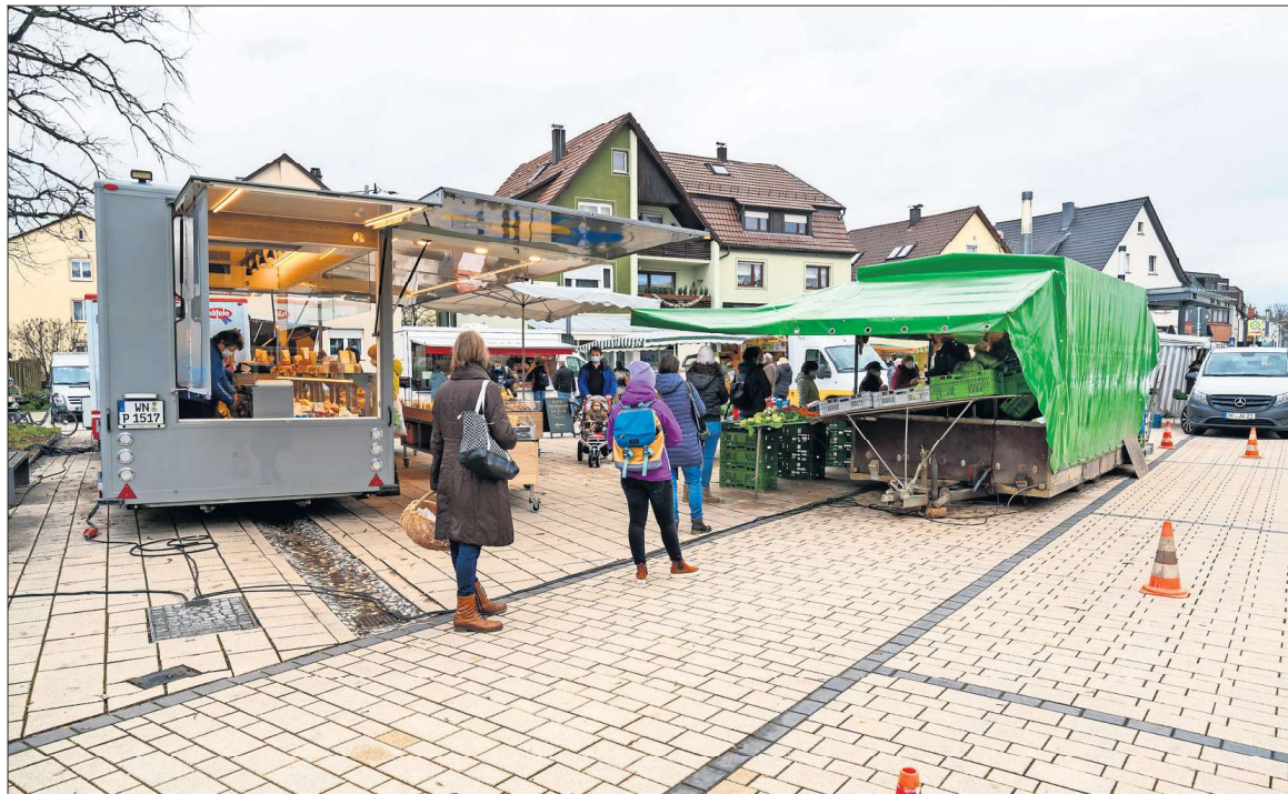
Zwischen Straße, Parkplätzen und Ernst-Bauer-Platz gibt es keine hohen Bordsteine – ein Vorteil nicht nur für Menschen mit Gehbehinderung, sondern ebenso für Senioren und Mütter mit Kinderwagen.
